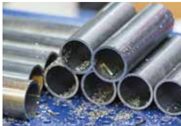
Extremidades com rebarbas em tubos metálicos cortados.
