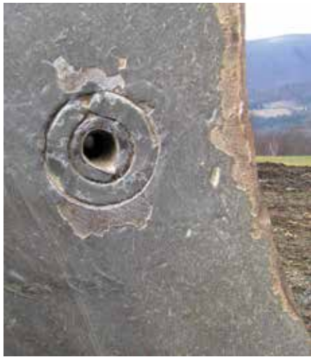
Combinação de Pinos: Os pinos com fenda são posicionados a 180° um do outro
