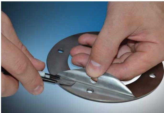
O ajuste de Calços Laminados Agrupados pela Superfície deve ser feito com a ajuda de uma ferramenta.
