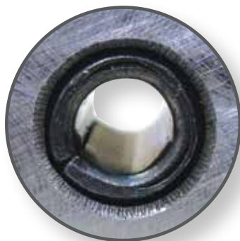
O Pino Elástico com fenda perder a sua flexibilidade quando a fenda está fechada.
