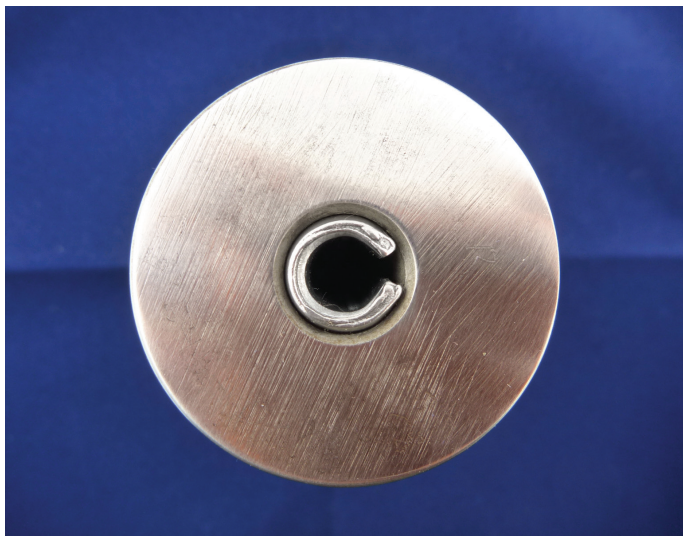
Figura 6: Pino Elástico instalado em um furo maior do que o recomendado.
