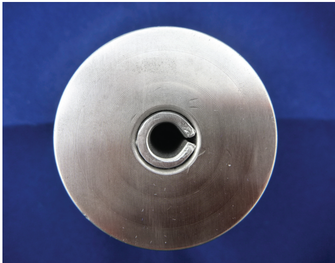
Figura 5: Pino Elástico instalado em um furo com diâmetro nominal conforme recomendado. Note que a fenda está praticamente fechada no diâmetro interno do pino.
