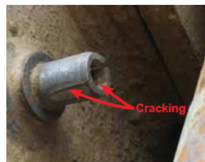
Figura 3: Um Pino Elástico pode flexionar apenas na área de 180° oposta a sua fenda, algo como o abrir e fechar de um livro.
