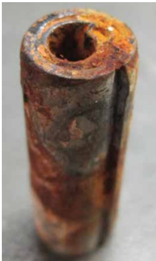
Figura 3: Esta fotografia mostra a geometria básica de um Pino Espiral - formado por um determinado número de camadas metálicas. Através da galvanização não é possível penetrar entre as camadas do pino espiral e os revestimentos por imersão, embora capazes de cobrir a parte interna, permanecem ineficientes para estas áreas.
