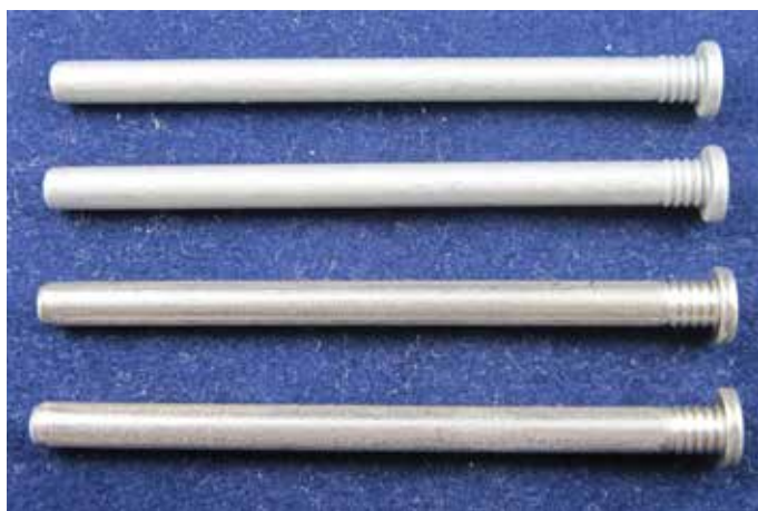
Figura 5: Pinos antes dos testes: os dois de cima são fabricados em aço de baixo carbono com acabamento lamelar de zinco, os dois de baixo são fabricados em aço inoxidável austenítico 305.
