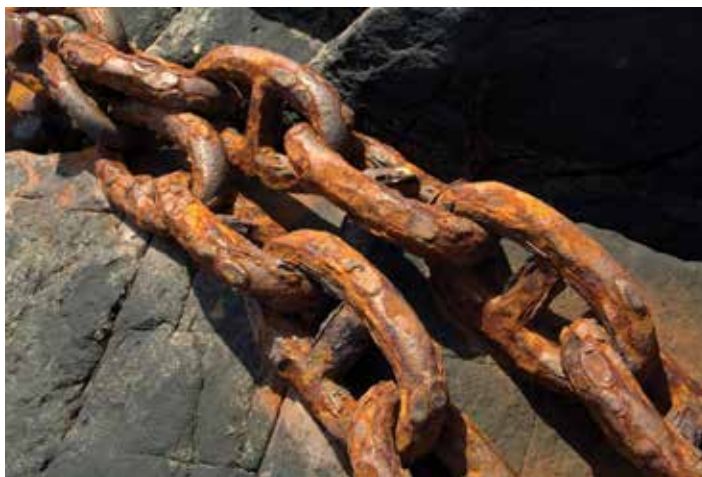
Figura 1. Cadeia de ferrugem demonstra perda de material devido à ferrugem ou ataque comum.
