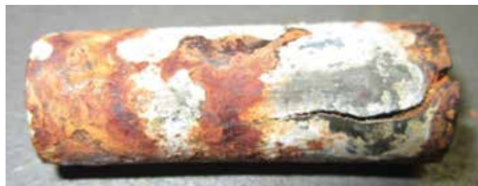
Figura 2: Como acabamento, este Pino Espiral recebeu um revestimento de zinco para cargas leves e uma imersão em cromato. O acabamento foi avaliado por 48 horas para detectar qualquer formação de ferrugem 'vermelha'. Quando mantido em pulverização de sal por 200 horas, este item apresentou uma grande formação de ferrugem vermelha apesar de ainda haver um pouco de zinco e ferrugem branca. Onde houver a presença de zinco na superfície, a peça continuará livre de ferrugem vermelha independentemente da gravidade do ataque em áreas adjacentes.
