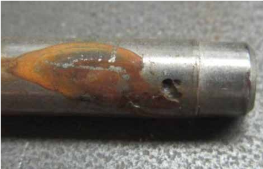
Figura 9: Corrosão por pites em um Pino Sólido fabricado em Aço Inoxidável 410, apresentando coloração correspondente.
