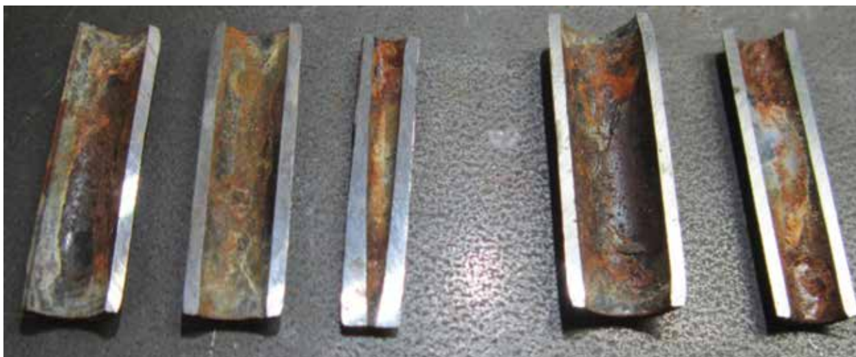
Figura 4: Para demonstrar o ataque entre as espirais (ou camadas) de aço do pino, a fotografia abaixo foi tirada depois que cortes transversais foram realizados no pino mostrado na Figura 3.
