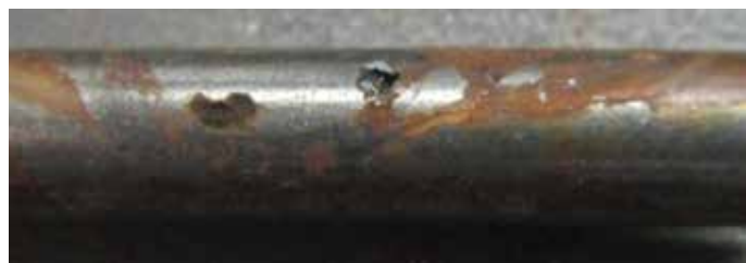
Figura 7: Corrosão por pites em um Pino com Fenda fabricado em Aço Inoxidável 420, apresentando coloração correspondente.
