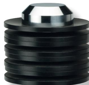
Durante a operação, essa tensão de tração muda para tensão de compressão. A resistência à fadiga é drasticamente reduzida por esta reversão de tensão. Manter a Mola Prato em uma constante pré-carga de no mínimo 15% de deflexão elimina tais reversões de tensão e aumenta a vida útil da Mola Prato.
