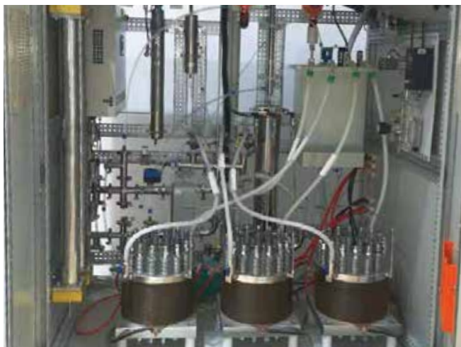
Produção de hidrogênio por eletrolisador
