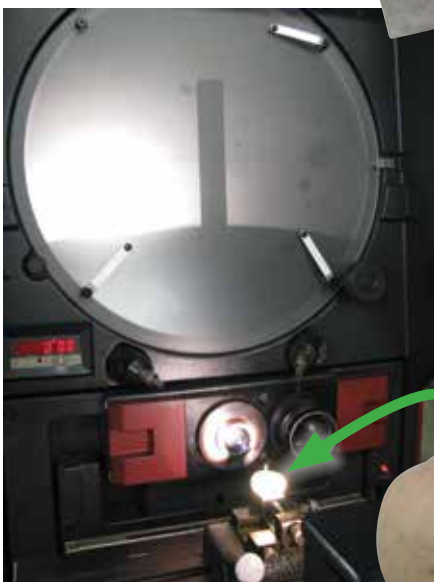
Figura 6b. Comparador Ótico e Pino em Massa de Modelar
