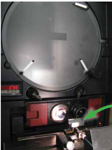
Figura 6a. Comparador Ótico e Pino em Bloco V
