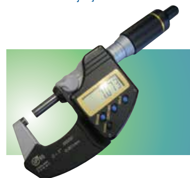
Figura 2b. Micrômetro convencional
