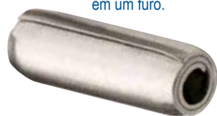
Figura 2. A lacuna do Pino Elástico com ranhura é fechada quando ele é instalado em um furo.
