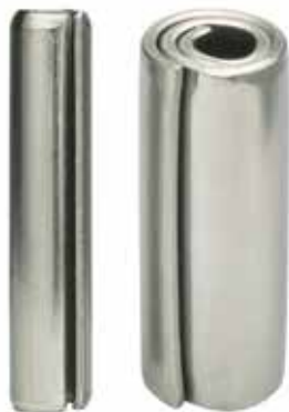
Figura 1. À esquerda, Pinos Elásticos com ranhura têm formato em “C”. À direita, Pinos Espirais têm 2 ¼ camadas de material laminado.
