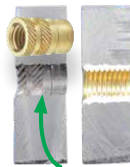
Figura 2. Fluência adequada do plástico
