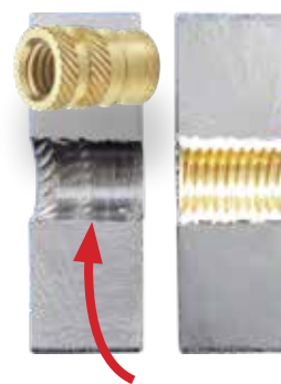
Figura 3. Fluência inadequada do plástico
