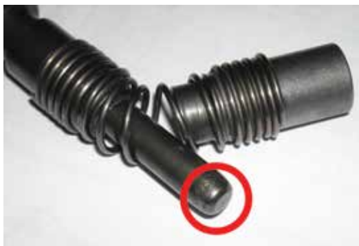
Figura 3. Punção de Inserção Desgastado
