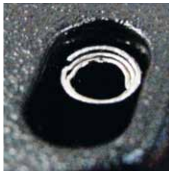
Figura 4. O uso de uma ferramenta de instalação incorreta faz com que o pino apresente o efeito telescópico ou se desenrole.
